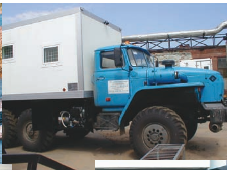
Электроагрегат АДА 12 - Т 400 РЯ на изделиях специального исполнения.
