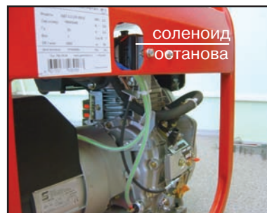
Защитное отключение при минимальном давлении масла
