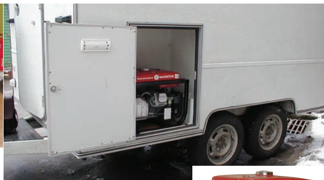
АБП 2,7-230 ВХБГ серийно устанавливается в прицеп "Тонар"
